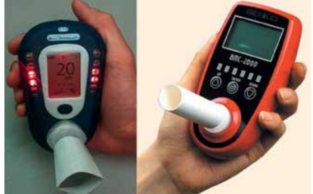
Рисунок 1.6. Пристрої для моніторингу окису вуглецю (CO)
